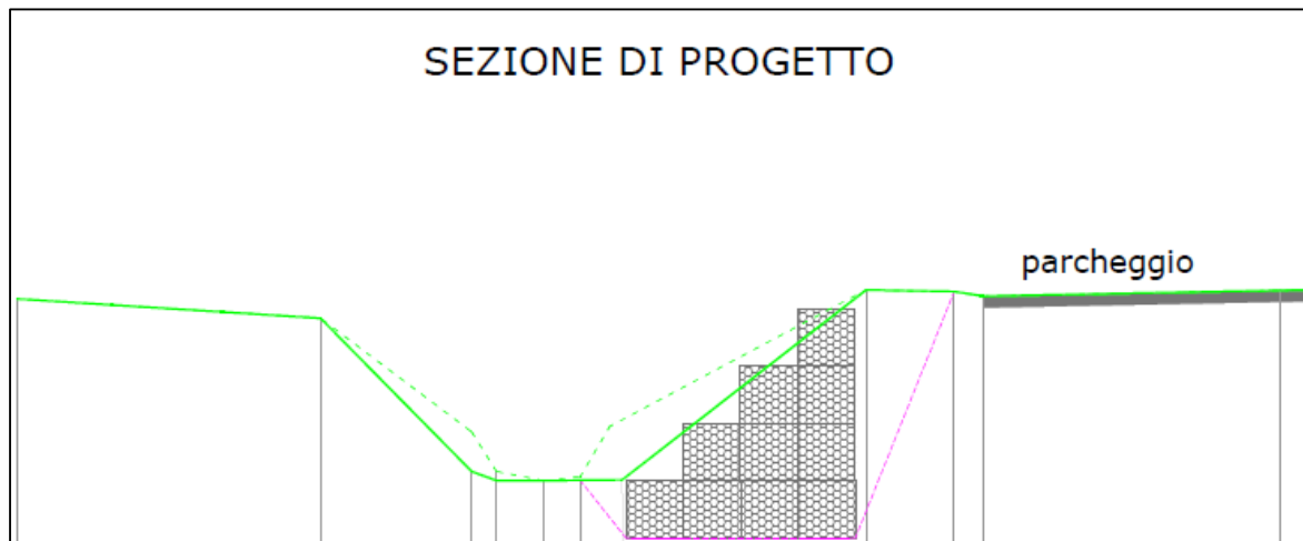
Fig. 3.3 – Intervento C: sezione tipo della gabbionata di difesa di sponda (tratteggiata in verde è indicata la sezione attuale).
