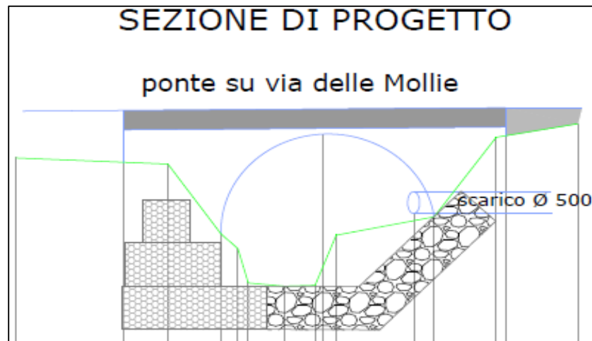
Fig. 3.5 – Intervento G: sezione tipo della gabbionata di difesa di sponda (tratteggiata in verde è indicata la sezione attuale).
